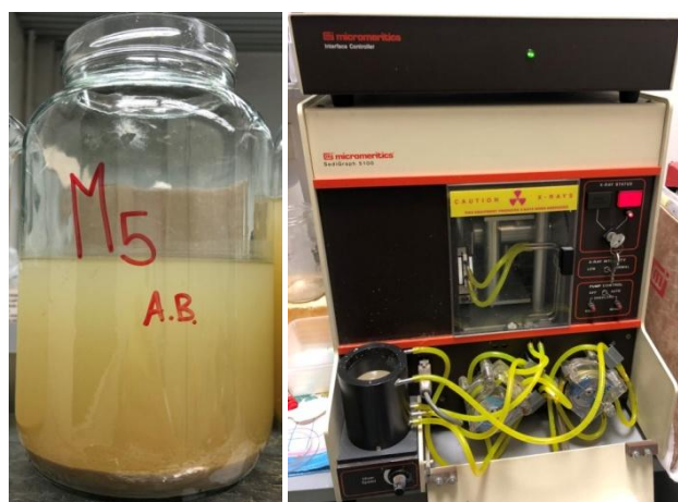
Slika 11. Suspenzija uzorka M5 prije pripreme (lijevo) korištena za rad na sedigrafu „Micromeritics 5100“ (Micromeritics Instrument Corporation) (desno); Geološko-paleontološki zavod PMF-a.
