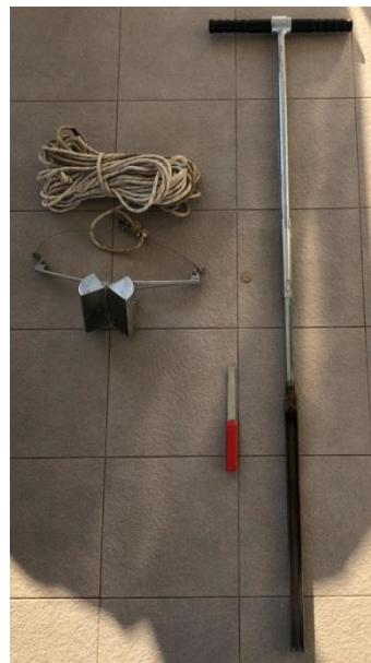
Slika 8. Korištena terenska oprema, lijevo je prikazano Van Veen-ovo grabilo, u sredini nožić i desno jezgrilo s udubljenjem na vrhu.
