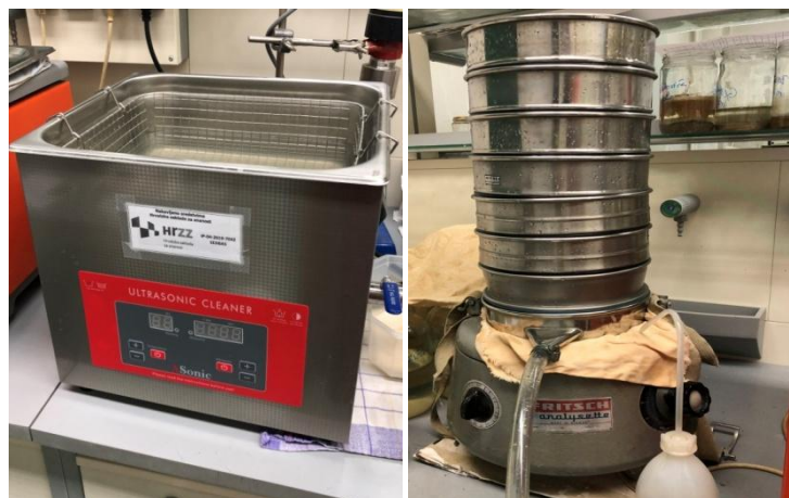
Slika 10. Znanstvena oprema korištena za metodu mokrog sijanja: ultrazvučna kada (lijevo); Fritsch Analysette® tresilica sa setom od sedam Retsch®ASTM sita (desno); Geološko-paleontološki zavod PMF-a.
