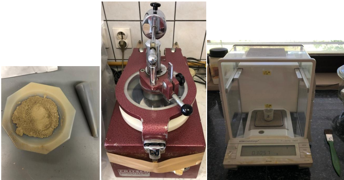
Slika 14. Znanstvena oprema korištena za pripremu uzoraka za kalcimetriju; ahadni tarionik (lijevo), ahadni mlin Fritsch Pulverisette® (sredina), analitička vaga Mettler Toledo AT261 DeltaRange® (desno); Mineraloško-petrografski zavod PMF-a.
