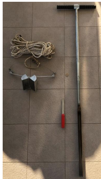
Slika 8. Korištena terenska oprema, lijevo je prikazano Van Veen-ovo grabilo, u sredini nožić i desno jezgrilo s udubljenjem na vrhu.
