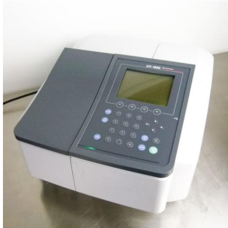
Slika 11. Spektrofotometar Shimadzu UV-VIS 1800.
