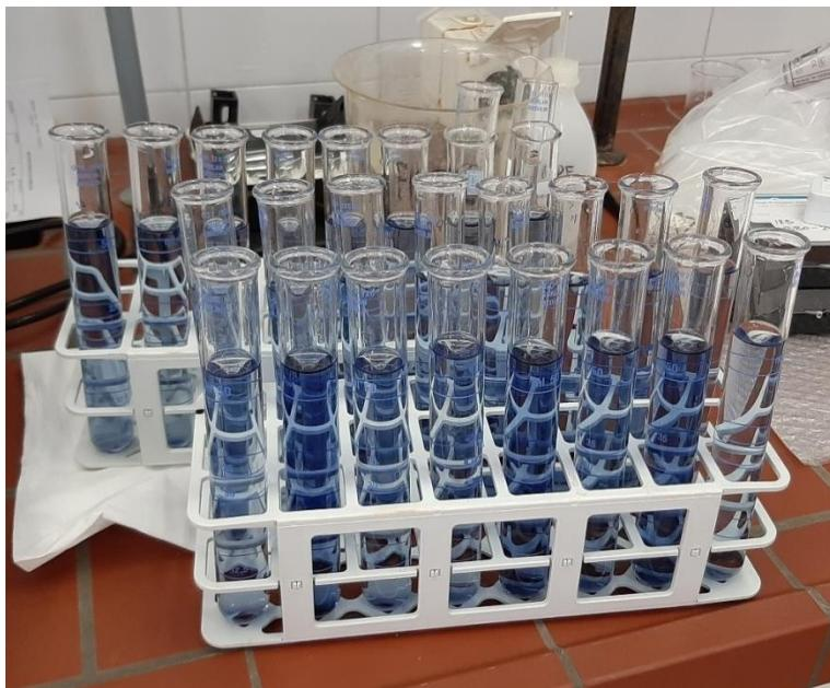
**Slika 13.** Pripremljeni uzorci za analizu ortofosfata na spektrofotometru
