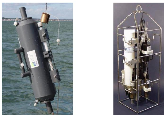
**Slika 9.** a) Niskinov crpac - alat za uzorkovanje morske vode (preuzeto: <https://www.google.com/search?q=5L+niskinov+crpac>) i b) CTD sonda (engl. Conductivity, Temperature, Depth) za mjerjenje osnovnih oceanografskih parametara (preuzeto: <https://www.google.com/search?q=CTD+SeaBird25+multiparametarske+sonde>).
