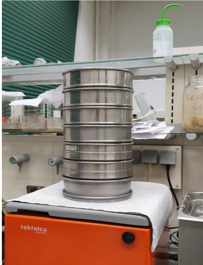
Slika 3. Set sita korišten za tehniku mokrog sijanja.
