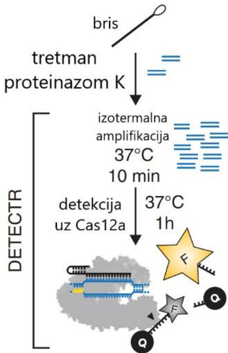
**Slika 7.** Shematski prikaz metode DETECTR. Iz brisa pacijenta oslobađaju se nukleinske kiseline tretmanom sa proteinazom K. Potom se uz izotermalnu amplifikaciju umnaža sva DNA u uzorku. Konačno, crRNA dizajnjirana je da prepozna virusnu DNA i aktivira *in trans* cijepanje DNA-FQ čime nastaje florescencija.
