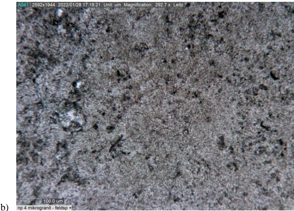
**Slika 5.5.10 Mikrofotografije uzorka NP4.** Vidi se granofirična tekstura u mikrogranitu. a) N(+), b) N(-).
