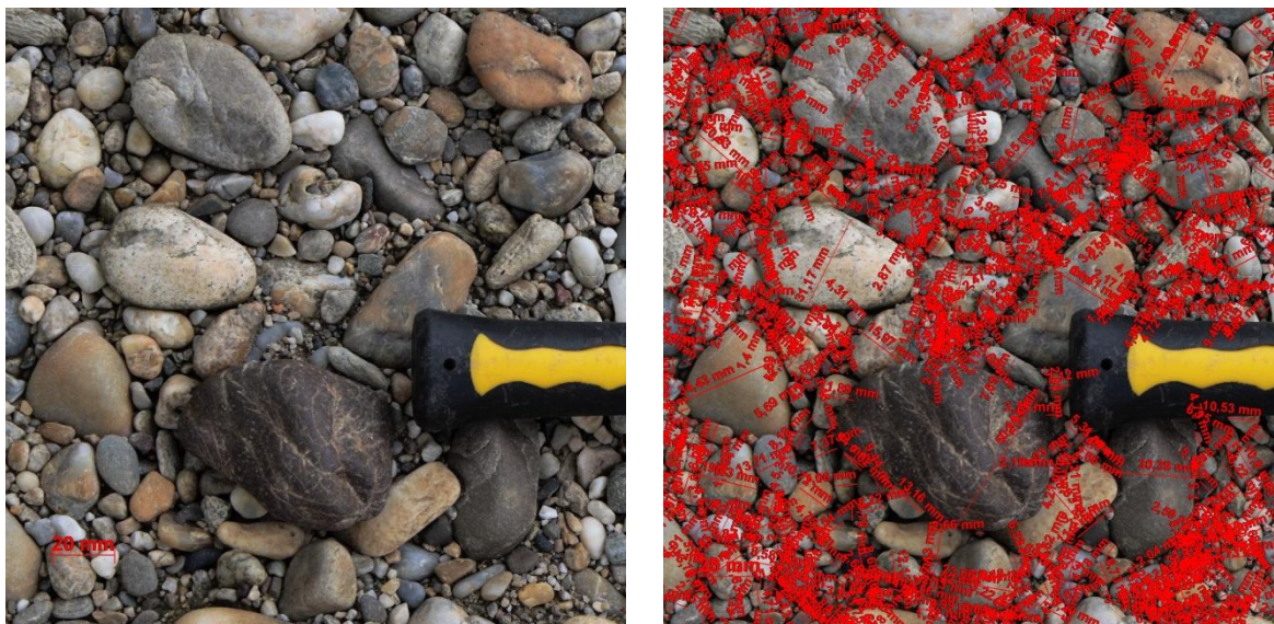
Slika 4.7a) Fotografija krupnozrnatkog sedimenta pruda na lokalitetu Rapeški most i mjerilo, fotouzorak šljunka LORI b) fotografija sedimenta sa prikazanim duljinama mjerenih osi valutica.
