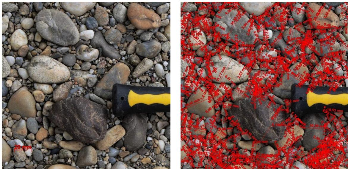
Slika 4.7a) Fotografija krupnozrnatog sedimenta pruda na lokalitetu Rapeški most i mjerilo, fotouzorak šljunka LORI i b) fotografija sedimenta sa prikazanim duljinama mjerjenih osi valutica.
