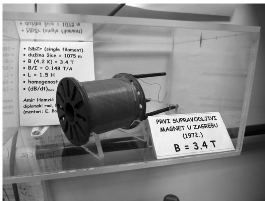
Slika 1. Prvi supravodljivi magnet u Zagrebu ( \text{NbZr} , B = 3.4\text{ T} ) konstruirao je prof. dr. sc. Amir Hamzić 1972. godine.
