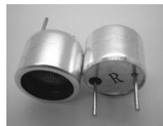
Prijamnik prima signale u širem rasponu ultrazvučnih frekvencija. Spojen je na kućište pojačala signala.
