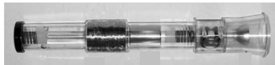
**Pribor:** zavojnica, magnet, LED, plastična cijev, spojne žice, gumeni čepovi, predzgotovljeni elektronički dio (dioda ili diode, otpornik, kondenzator).
