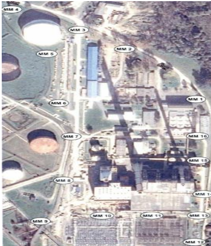
Sl. 8. Prikaz mjernih mjesta za mjerenje razine buke
