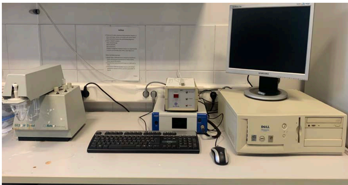
Slika 10. 663VA Stand troelektrodni sustav povezan s \mu AUTOLAB potenciostatom/galvanostatom, IME jedinicom i osobnim računalom opremljenim GPES 4.9. programom.
