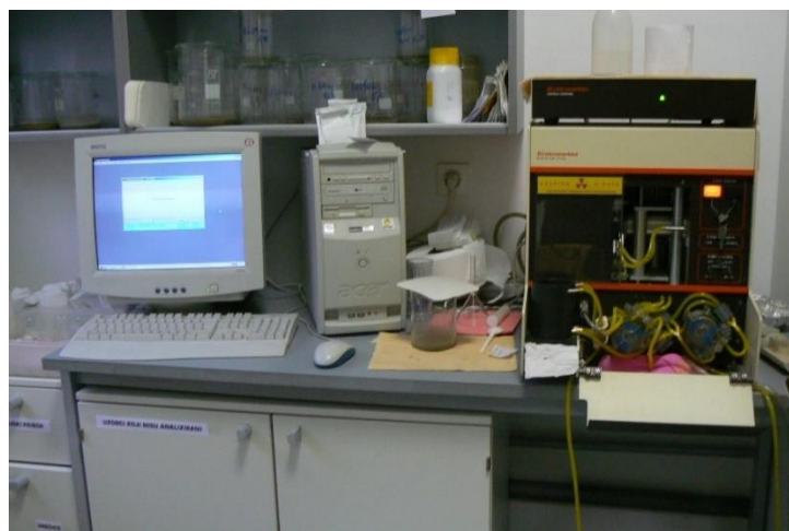
Slika 7. Uređaj SediGraph 5100 s računalom. Fotografirao Šimun Aščić.
