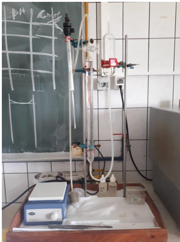
Slika 8. Scheiblerova aparatura za određivanje udjela karbonata u uzorku s magnetnom mješalicom. Fotografirala Nina Furčić.
