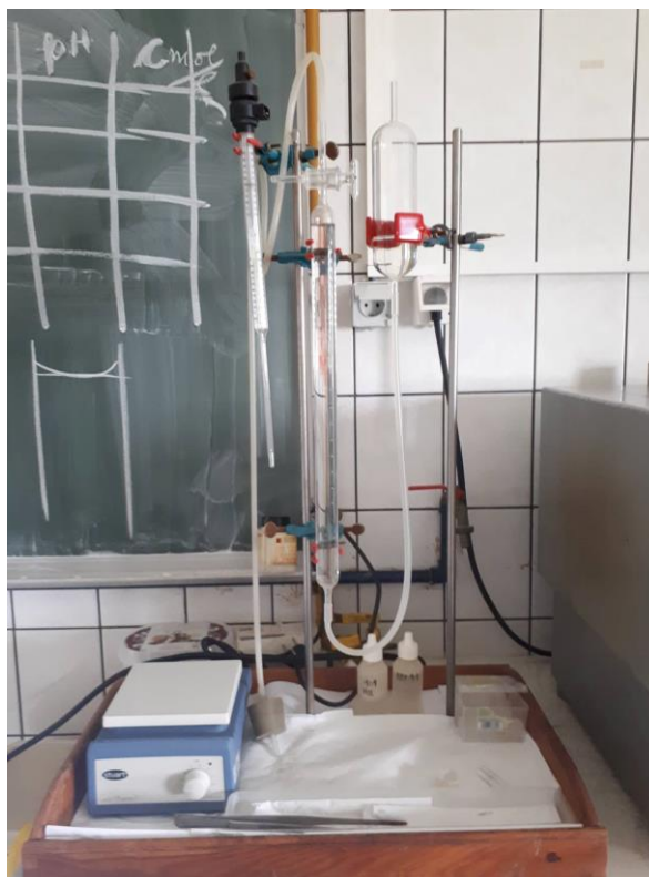
Slika 8. Scheiblerova aparatura za određivanje udjela karbonata u uzorku s magnetnom miješalicom. Fotografirala Nina Furčić.
