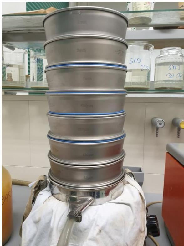
Slika 6. Sita za prosijavanje uzorka s promjerima 4 mm, 2 mm, 1 mm, 0,5 mm, 0,25 mm, 0,125 mm i 0,063 mm. Fotografirala Stella Šušnjar.
