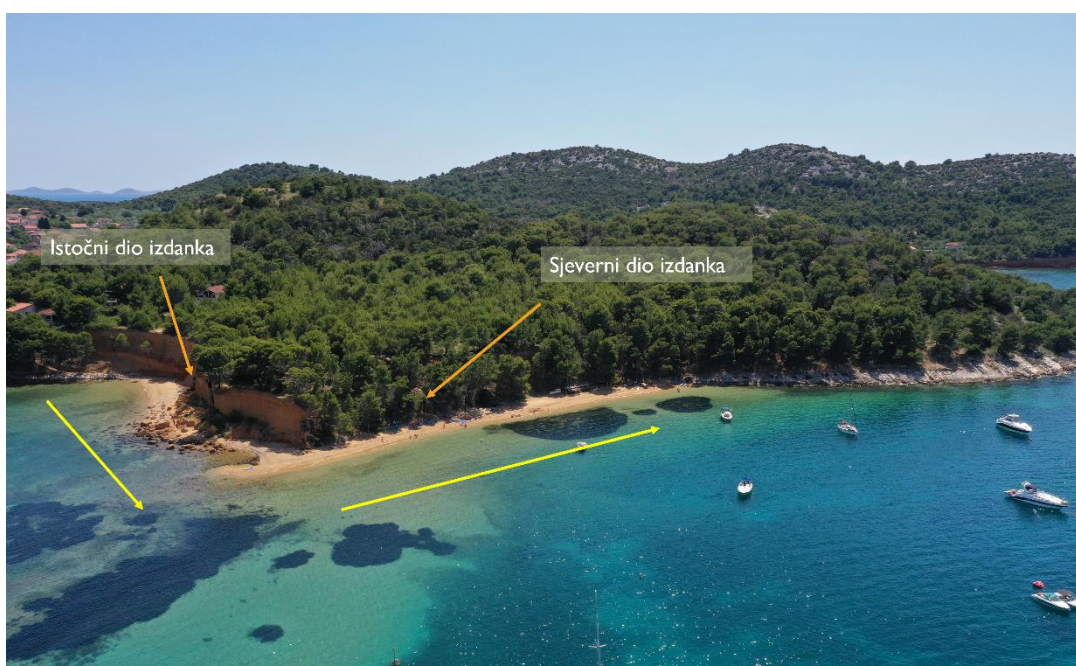
Slika 4. Fotografija istočnog i sjevernog dijela pleistocenskih izdanaka; žute strelice označavaju pretpostavljeni dužobalni transport
