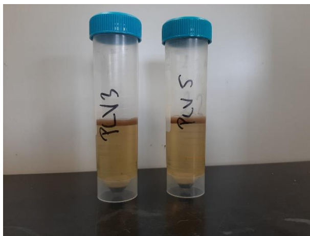
Slika 8. Razdvojena teška i laka frakcija nakon centrifugiranja
