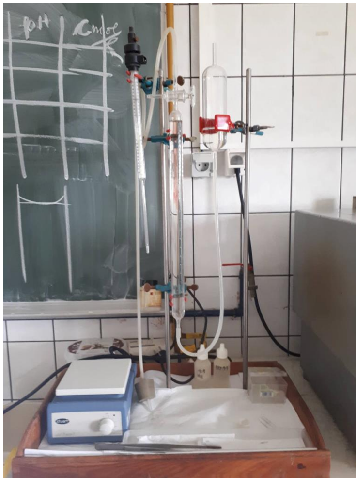
Slika 7. Scheiblerova aparatura za određivanje udjela karbonata
