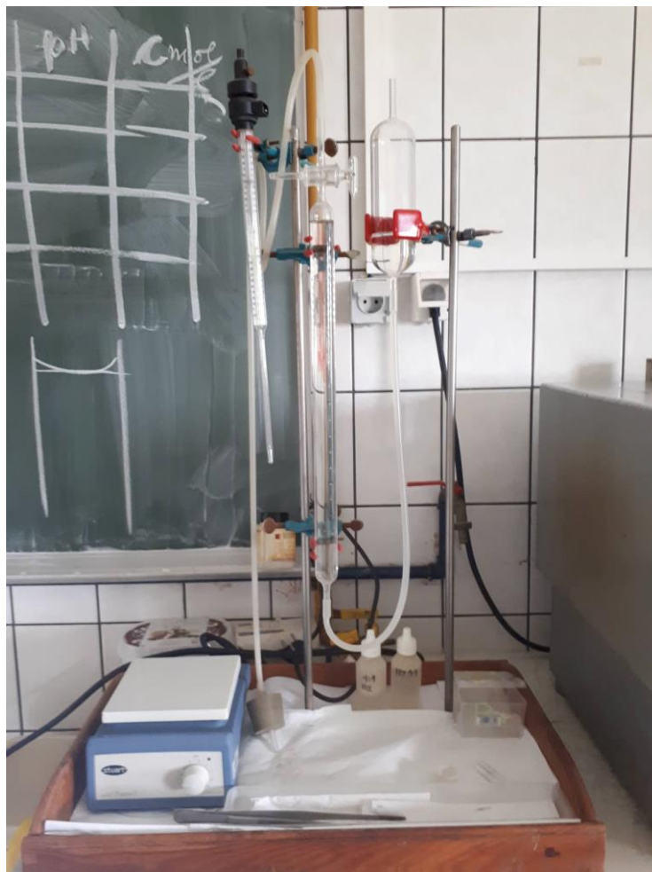
Slika 7. Scheiblerova aparatura za određivanje udjela karbonata
