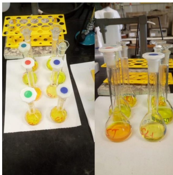
Slika 13. Dekantirana otopina uzorka četvrtog koraka BCR protokola u tikvice od 50 ml, laboratorij Mineraloško-petrografskog zavoda Geološkog odsjeka Prirodoslovno-matematičkog fakulteta u Zagrebu.
