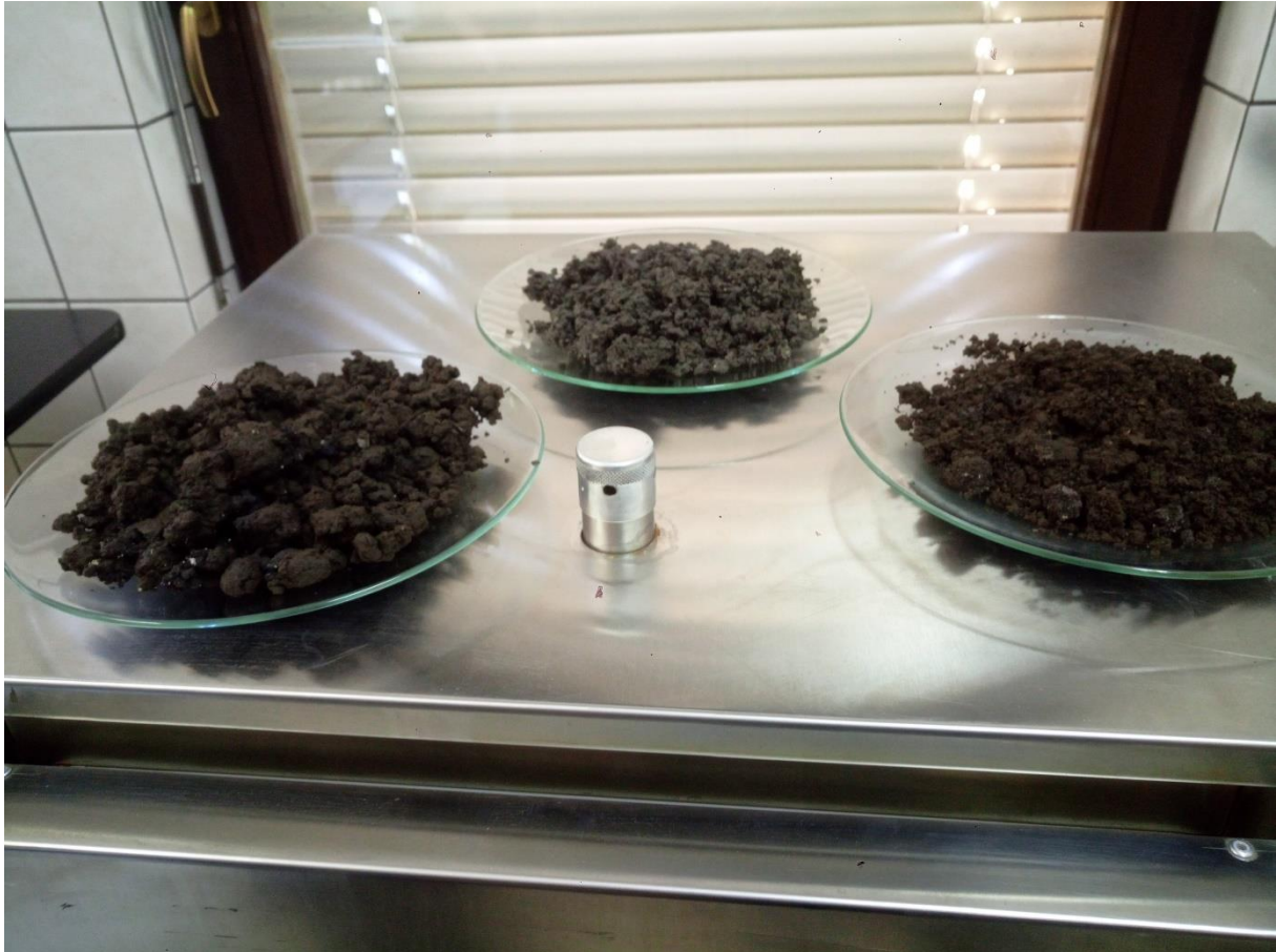
Slika 7. Uzorci mulja nakon sušenja na 80 °C, laboratorij Mineraloško-petrografskog zavoda Geološkog odsjeka Prirodoslovno-matematičkog fakulteta u Zagrebu.
