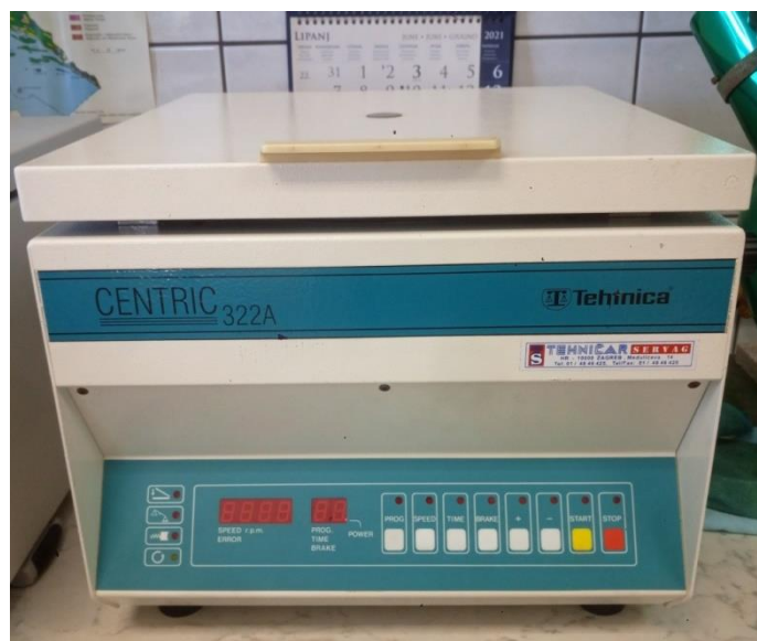
Slika 11. Uređaj za centrifugiranje, laboratorij Mineraloško-petrografskog zavoda Geološkog odsjeka Prirodoslovno-matematičkog fakulteta, u Zagrebu.
