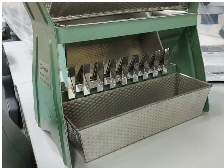
Slika 6. Mikrospliter korišten za standardizaciju uzorka
