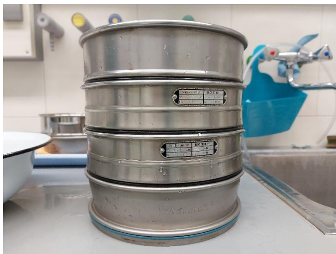
Slika 5. Četiri sita promjera mrežice 500, 250, 125 i 63 \mu m
