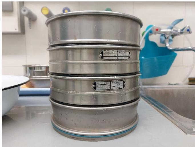
Slika 5. Četiri sita promjera mrežice 500, 250, 125 i 63 µm
