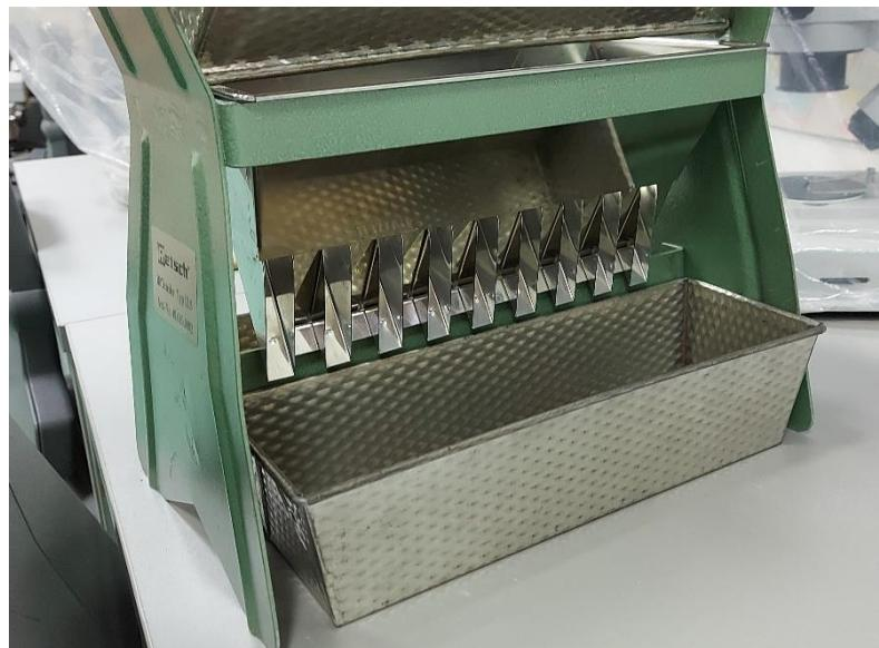
Slika 6. Mikrospliter korišten za standardizaciju uzorka
