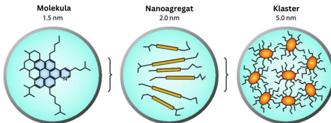
Slika 1. Prikaz Yen-Mullinsovog „modela otoka“ i formiranje nanoagregata i klastera 8
