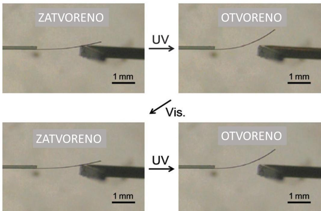
Slika 14. Fotoreverzibilno otvaranje i zatvaranje strujnog kruga kontrolirano UV zračenjem i vidljivom svjetlošću.<sup>31</sup>
