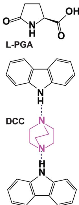
Slika 10. Strukture L-piroglutaminske kiseline i kokristala diazobiciklo[2.2.2]oktan-karbazola. Slika preuzeta i prilagođena prema izvoru.<sup>24</sup>
