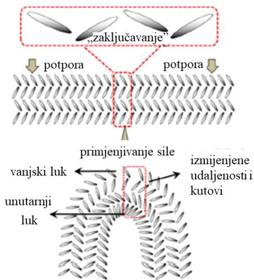
Slika 3. Model elastičnog savijanja kristala. Slika preuzeta i prilagođena prema izvoru.<sup>10</sup>
