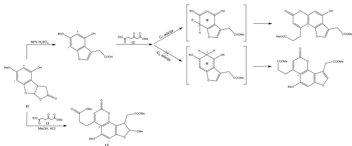
Slika 6. Mehanizmi nastajanja željenog i neželjenog produkta Pechmannove kondenzacije.
