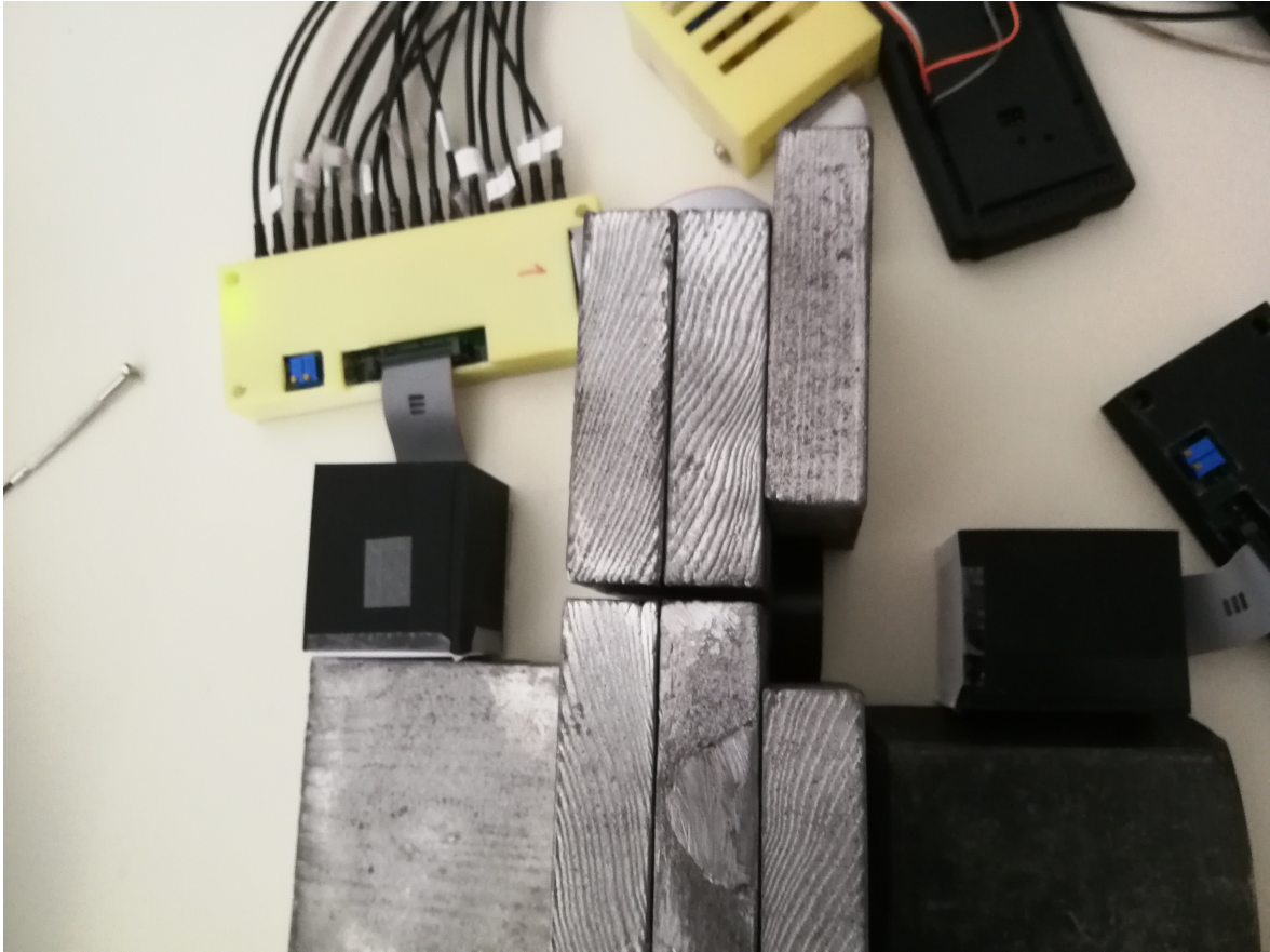
Slika 3.5: Eksperimentalni postav kada se promatra interakcija s gama zračenjem na zadanoj dubini
