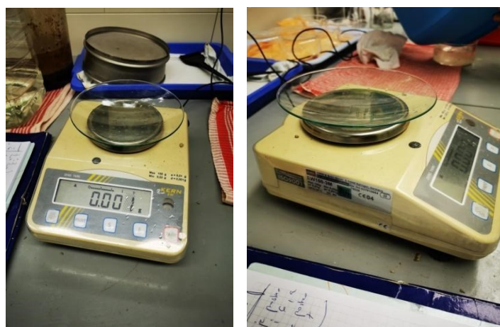
Slika 11. Vaga korištena za određivanje mase suhih uzoraka.
