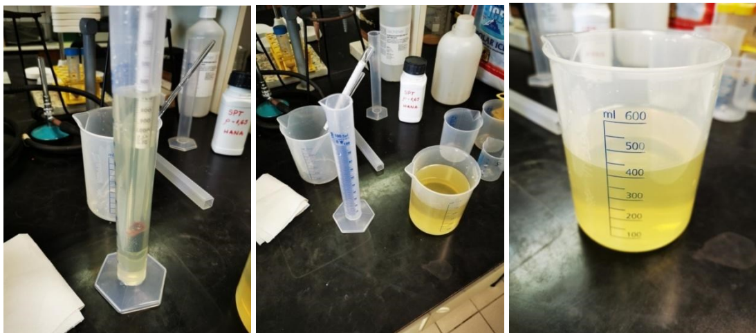
Slika 20. a) Areometar za određivanje točne gustoće otopine. b) Proces dobivanja otopine odgovarajuće gustoće. c) SPT otopina odgovarajuće gustoće.
