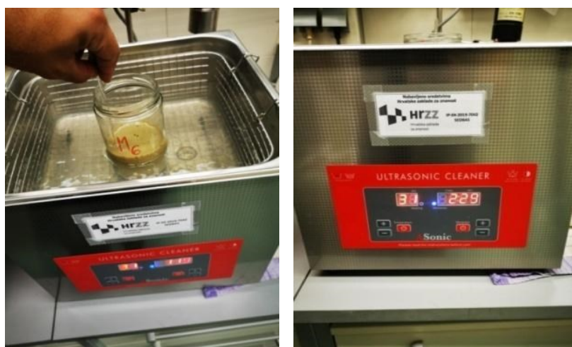
Slika 12. Potapanje uzoraka u ultrazvučnoj kupki.
