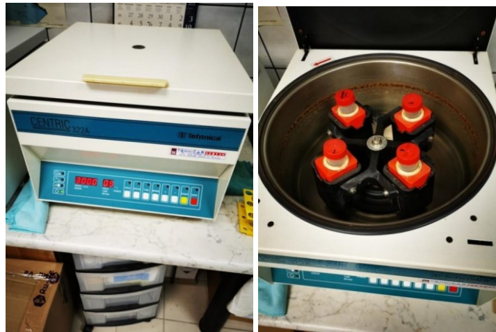
Slika 22. Laboratorijska centrifuga modela Tehtnica Centric 322A proizvođača Domel te kivete sa uzorcima i SPT otopinom spremni za centrifugu.
