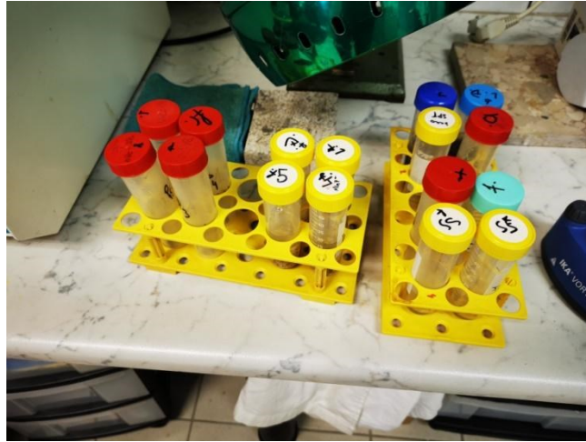
Slika 21. Kivete sa uzorcima i SPT otopinom, spremni za centrifugu.
