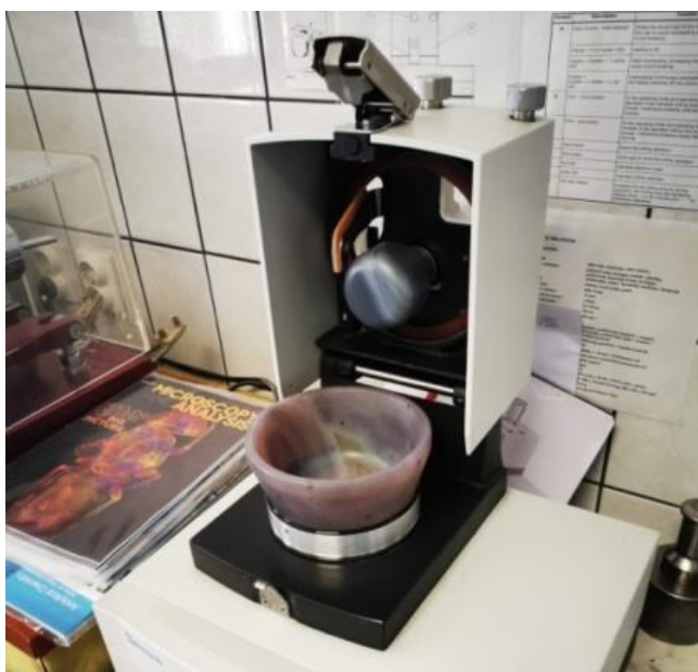
Slika 17. Na slici je prikazan Retsch mlin RM200 kojim su se uzorci usitnili te pripremili za daljnju analizu.
