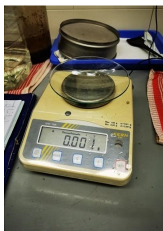
Slika 11. Vaga korištena za određivanje mase suhih uzoraka.
