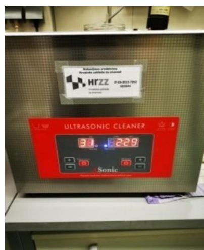
Slika 12. Potapanje uzoraka u ultrazvučnoj kupki.
