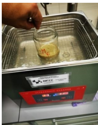
Slika 12. Potapanje uzoraka u ultrazvučnoj kupki.
