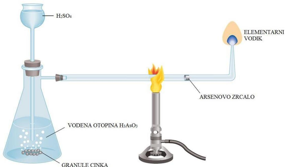
Slika 1. Aparatura za izvođenje Marshove probe (preuzeto iz ref 3, prilagođeno na hrvatski)
