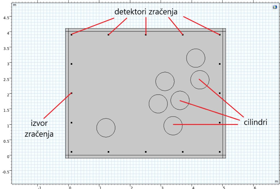
Slika 2 Skica prostora, razmještaj izvora, detektora i cilindara
