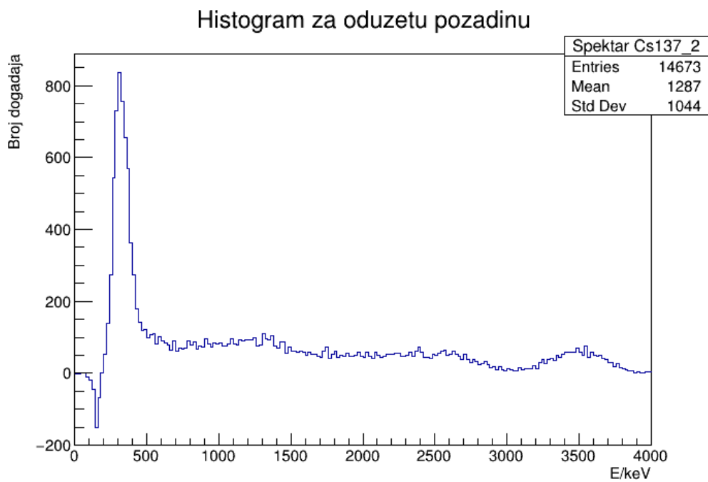
Slika 4.4 Spektar Cs sa oduzetom pozadinom. Vidljiv utjecaj ima šuma na niskim energijama.
