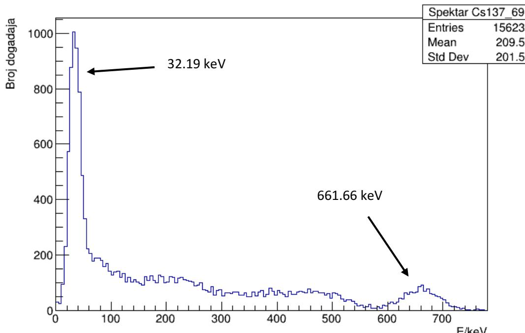
Slika 4.9: Kalibrirani spektri Am(a) i Cs(b) za mjerena od 60 minuta
