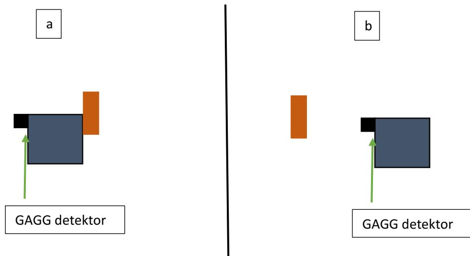
Ilustracija 4.1 Pozicije u kojima se nalazi radioaktivni izvor. Pozicija a) koristi se tokom mjerena, dok se pozicija b) koristi tokom kalibracijskih mjerena.
