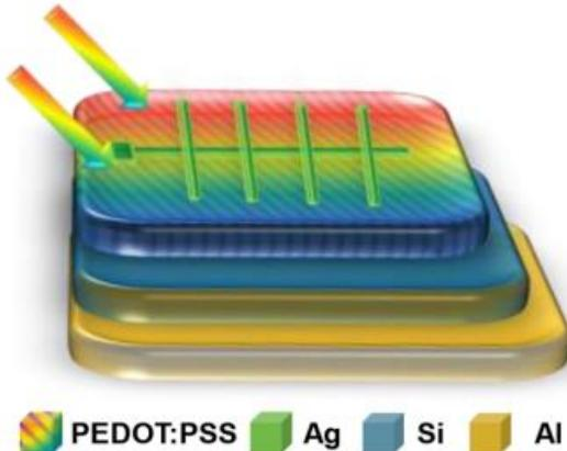
**Slika 17:** Slikoviti prikaz strukture hibridne solarne ćelije [33].
