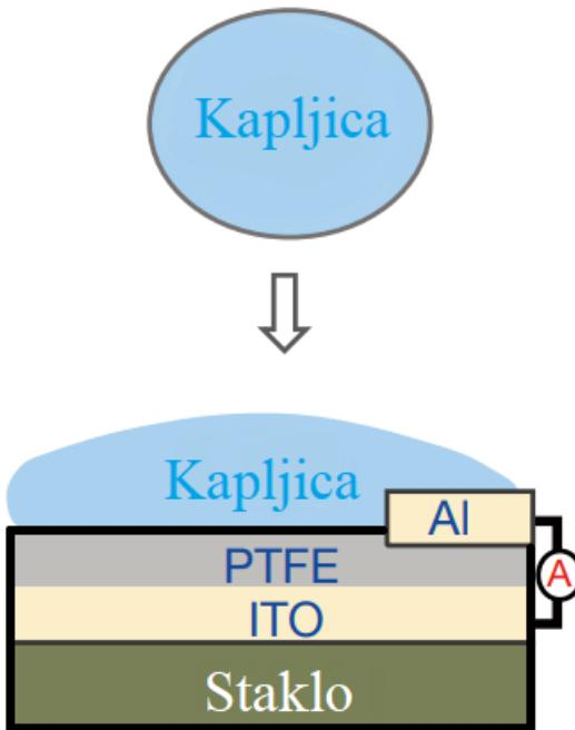
**Slika 9:** Shematski prikaz strukture DEG-a. Staklena podloga (zeleno), indijev kositrov oksid (ružičasto), politetrafluoroetilen (ljubičasto), aluminijeva elektroda (bež), kapljica vode (plavo) [24].
