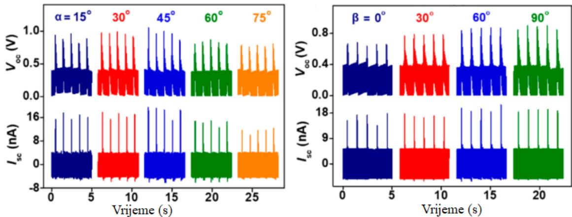
**Slika 22:** Grafički prikaz ovisnosti struje kratkog spoja ( $I_{SC}$ ) i napona otvorenog strujnog kruga ( $V_{OC}$ ) o vremenu za različit kut između ravnine površine uređaja i smjera pada kapljica ( $\alpha$ ) (lijevo) te kutu između smjera pada kapljica i strukture utisnute u PDMS ( $\beta$ ) (desno) [33].
