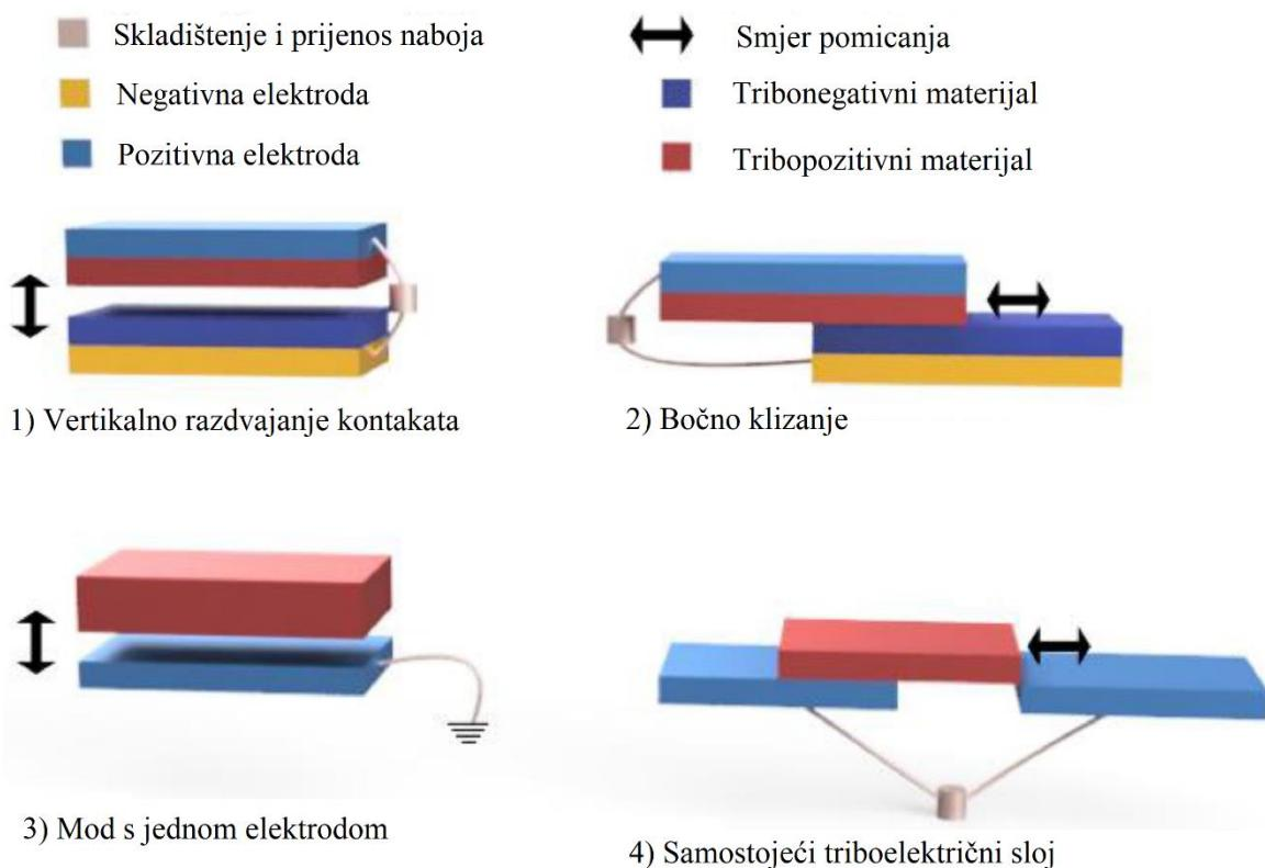
**Slika 7:** Različiti modovi rada triboelektričnog nanogeneratorsa: 1) Vertikalno razdvajanje kontakata, 2) Bočno klizanje, 3) Jedna elektroda i 4) Samostojeći triboelektrični sloj [25, 27].
