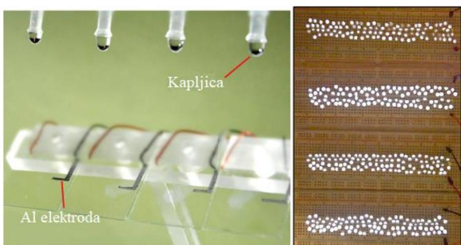
**Slika 14:** Slika postava četiri DEG-a na koje padaju kapljice vode (lijevo). Sto svjetlosnih dioda zasvjetli kada jedna kapljica padne na DEG (desno) [24].
