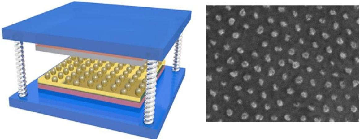
**Slika 8:** Shematski prikaz BCP-TENG-a dobivenog dodavanjem zlatnih nanotočaka BCP tehnikom (lijevo) i kontaktna površina materijala slikana skenirajućim elektronskim mikroskopom (SEM) nakon dodavanja nanotočaka zlata (desno) [28].
