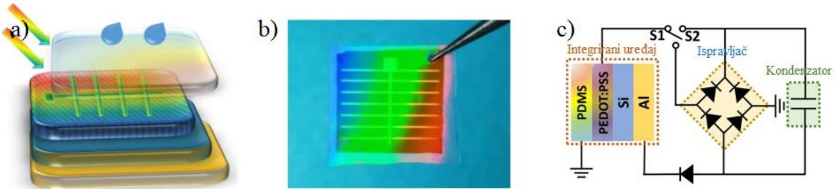
**Slika 23:** a) Shematski prikaz strukture uređaja koji električnu energiju daje iz sunčeve svjetlosti te kišnih kapi. b) Slika dobivenog uređaja. c) Dijagram strujnog kruga kojim se može opisati dobiveni uređaj [33].
