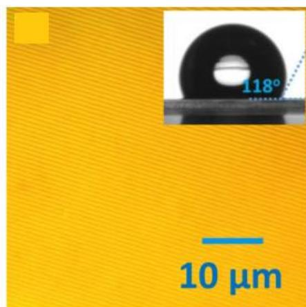
**Slika 16:** Utisnuti PDMS sloj uslikan optičkim mikroskopom. Boja je dobivena interferencijom svjetlosti zbog uzorka sloja. Umanjena slika pokazuje kontaktni kut kapljice vode sa slojem ( $\sim 118^\circ$ ) [33].
