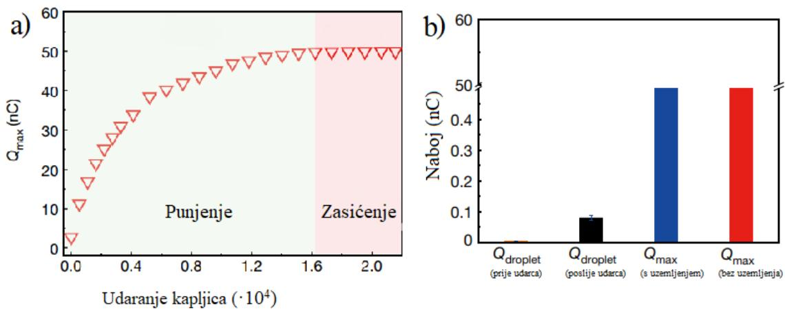
**Slika 10:** a) Grafički prikaz ovisnosti skupljenog naboјa o broju kapljica koje su udarile u uređaj. Sivi dio pokazuje da se naboј na površini uređaja konstantno povećavao sve dok nije postigao konstantnu vrijednost prilikom zasićenja (ružičasto) b) Naboј koji kapljice imaju ( $Q_{\text{droplet}}$ ) prije i poslije udarca u uređaj je zanemariv u odnosu na izmjereni naboј uređaja ( $Q_{\text{max}}$ ) [24].
