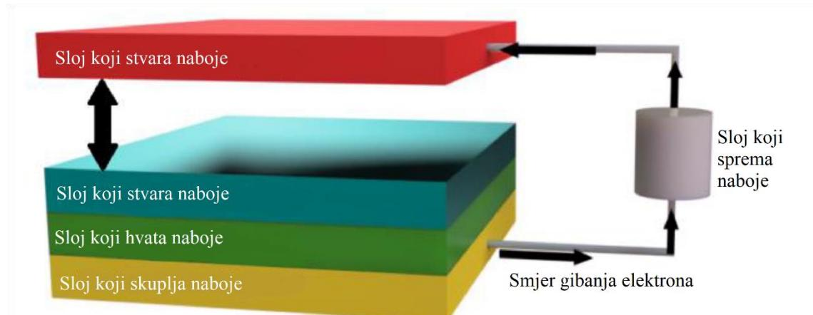
**Slika 6:** Struktura triboelektričnog nanogeneratora. Slojevi koji proizvode naboje (crveno i plavo), sloj koji hvata naboje (zeleno), sloj koji skuplja naboje (žuto) i sloj koji sprema naboje (sivo) [25].
