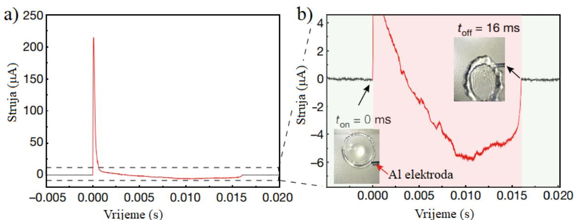
**Slika 11:** a) Grafički prikaz ovisnosti struje o vremenu tijekom pada kapljice. b) Ovisnost struje o vremenu za isti grafički prikaz sa smanjenom skalom te ubačenim slikama u trenutku širenja kapljice i prvog doticaja s aluminijevom elektrodom u  $t_{on}$  (vrijeme kada se uređaj „upalio“) te prilikom klizanja kapljice niz uređaj i zadnjeg kontakta u  $t_{off}$  (vrijeme kada se uređaj „ugasio“)[24]
