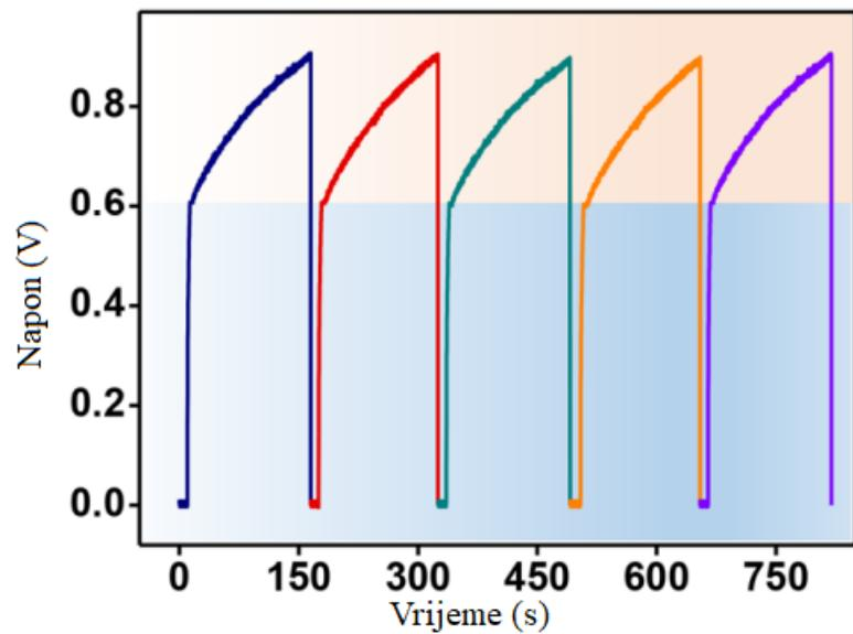
**Slika 24:** Ovisnost napona o vremenu za kondenzator kojeg puni integrirani uređaj. Plavo područje prikazuje punjenje kondenzatora kada je samo S2 prekidač zatvoren dok narančasto područje prikazuje punjenje kondenzatora kada je samo S1 prekidač zatvoren [33].
