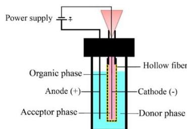
Slika 7. Aparatura korištена za izolaciju amfetamina iz uzorka urina. Preuzeto iz ref. 23
