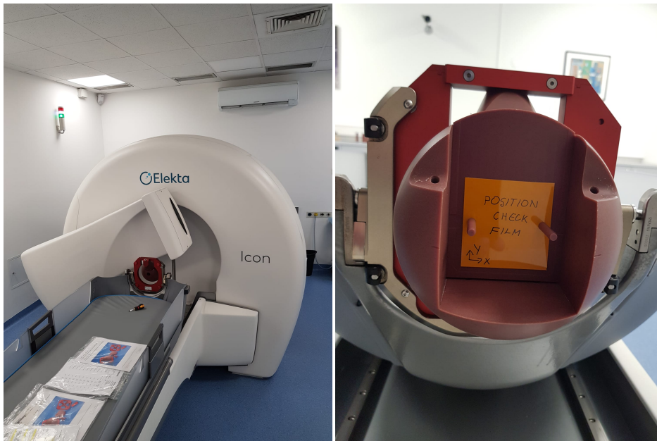
Slika 8.2: Lijevo: Korišteni LGK Icon i pridruženi CBCT uređaj, desno: kontrolni film u sfernom Solid Water fantomu.
