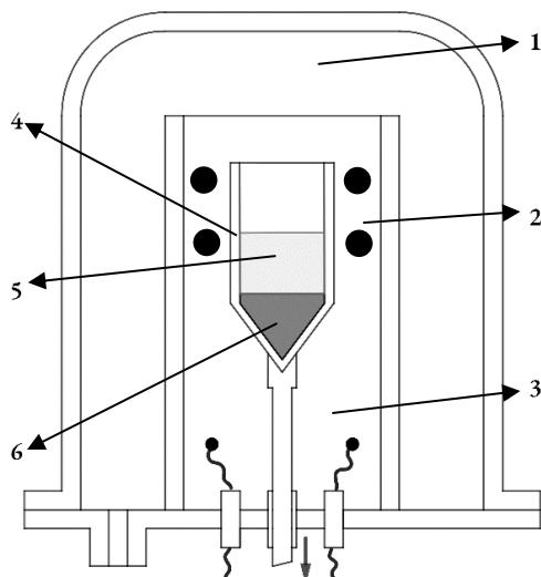
**Slika 11.** Uređaj za kristalizaciju prema Bridgman-Stockbargerovoj metodi. Dijelovi uređaja su: evakuirani prostor, 1; vrući dio peći, 2; hladniji dio peći, 3; posuda, 4; talina, 5; kristal, 6; slika preuzeta i prilagođena prema izvoru<sup>1</sup>
