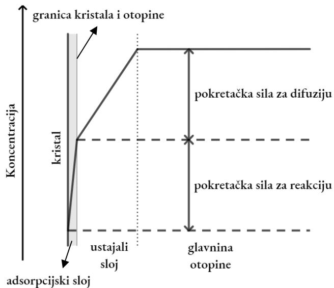
**Slika 3.** Mehanizam rasta kristala prema difuzijsko-integracijskoj teoriji, slika preuzeta i prilagođena prema izvoru<sup>5</sup>
