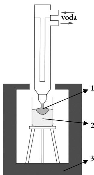
**Slika 12.** Uređaj za kristalizaciju prema Kyropoulosovoj metodi. Dijelovi uređaja su: jezgra kristala, 1; talina, 2; peć, 3; slika preuzeta i prilagođena prema izvoru<sup>1</sup>
