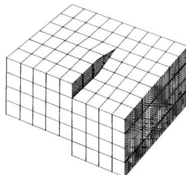
**Slika 5.** Shema vijčane dislokacije kubičnog kristala, slika preuzeta i prilagođena prema izvoru<sup>1</sup>
