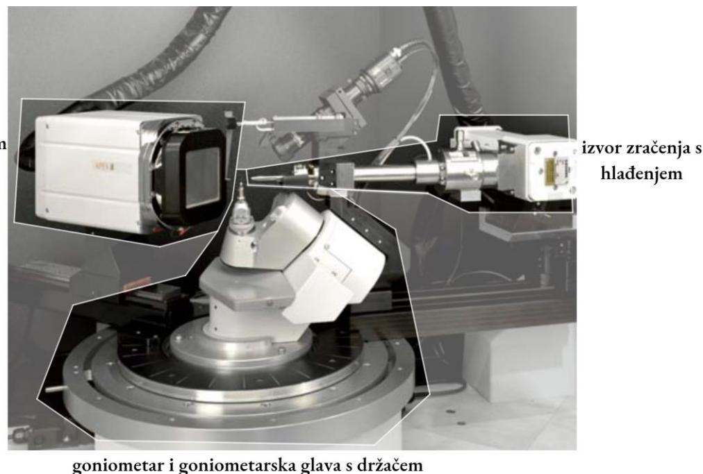
**Slika 8.** Fotografija difraktometra za difrakciju rendgenskih zraka u monokristalu, slika preuzeta i prilagođena prema izvoru<sup>19</sup>
