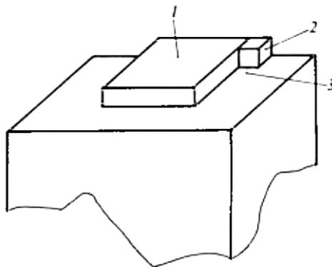
**Slika 4.** Shema rasta kristala na glatkoj plohi: pločasti nukleus, 1; točkasti nukleus, 2; središte rasta, 3; slika preuzeta i prilagođena prema izvoru<sup>1</sup>
