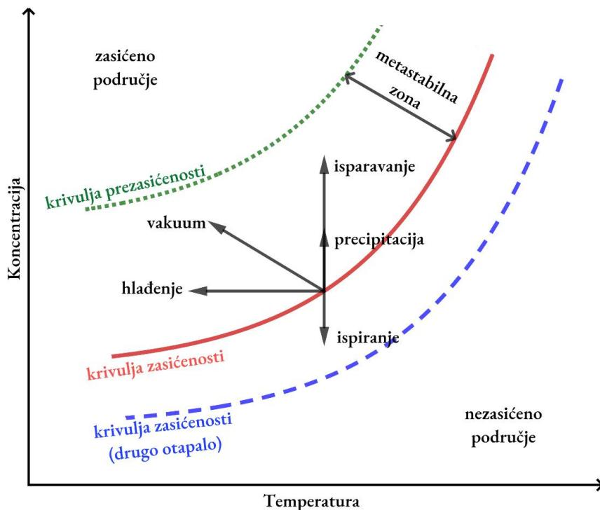
**Slika 2.** Dijagram zasićenosti-prezasićenosti, slika preuzeta i prilagođena prema izvoru<sup>2</sup>
