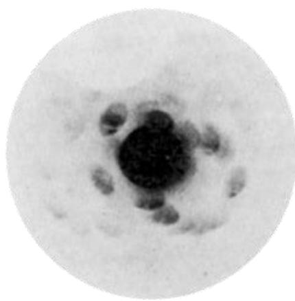
**Slika 6.** Prva snimljena difrakcijska slika kristala bakrovog(II) sulfata, slika preuzeta i prilagođena prema izvoru<sup>17</sup>
