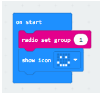
Slika 4.2.1 Postavljanje grupe za radio komunikaciju.
