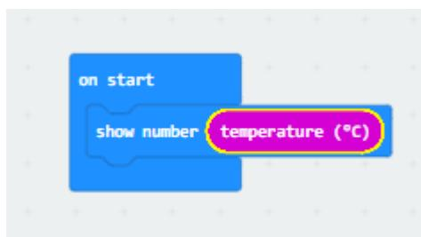
Slika 4.1 Kod za prikaz izmjerene temperature / snimka zaslona
