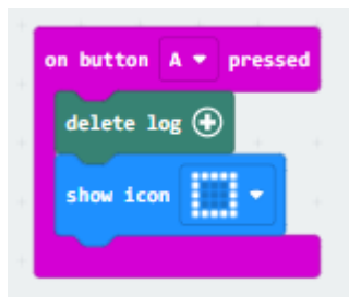
Slika 4.1.10 Dio koda za brisanje zapisnika podataka s micro:bita te prikaz ikone uz tu radnju.
