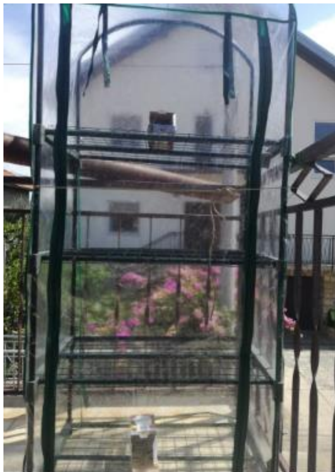
Slika 5.1.15 Jedan micro:bit s enviro:bit pločicom nalazi se na najvišoj (T gore), a drugi na najnižoj (T dolje) polici plastenika.
