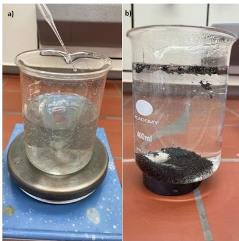
Slika 10. (a) Postupak nastajanja crnog taloga nanočestica željeza dodavanjem \text{NaBH}_4 (b) Magnetska separacija sintetiziranih nanočestica elementarnog željeza
