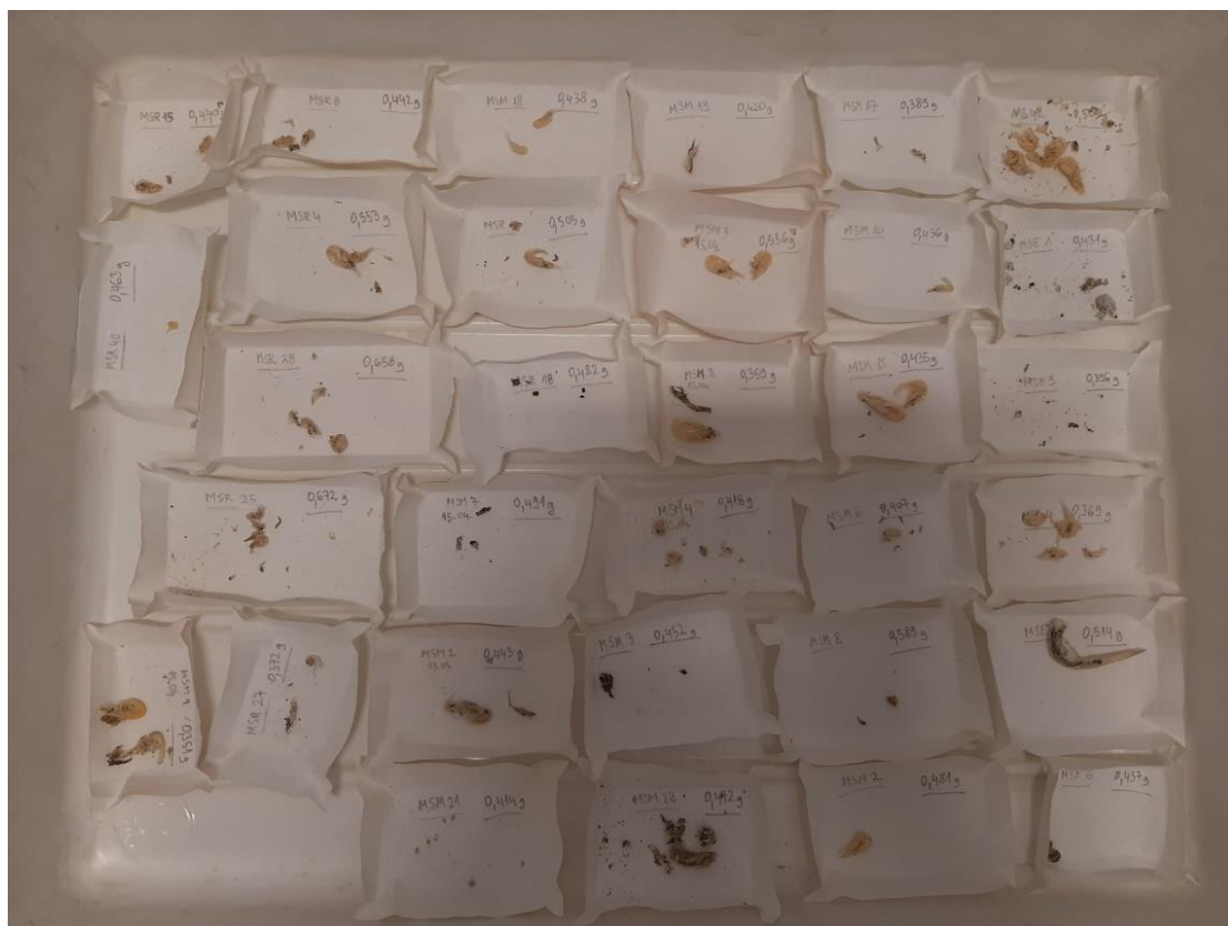
Slika 10: Prikaz sušenja sadržaja želudaca u ladicama od filter papira (foto: M. Talajić)
