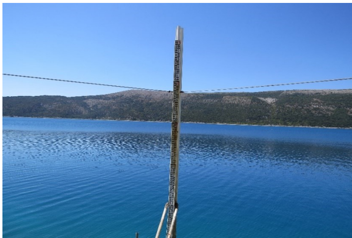
Fotografija 3. Vodomjerna letva na Vranskome jezeru
