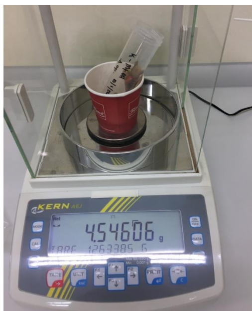
Slika 16. Prikaz vaganja tkiva češljače prije dodavanja otapala (Izvor: vlastita fotografija ; slikano u laboratoriju Metris u Puli)
