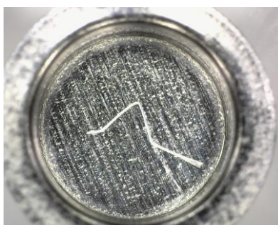
Slika 24. Kristal spoja A pripremljen za snimanje Ramanovom mikroskopijom
