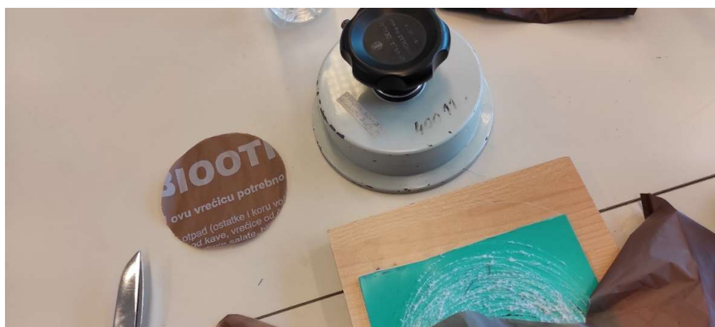
Slika 8. Priprema uzorka za određivanje plošne mase (izvor: Martina Fileš, 2021.)
