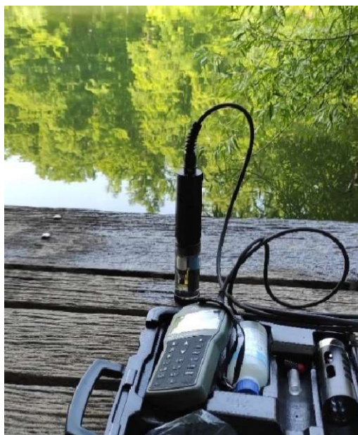
Slika 10. Određivanje pH vode (izvor: Martina Fileš, 2021.).
