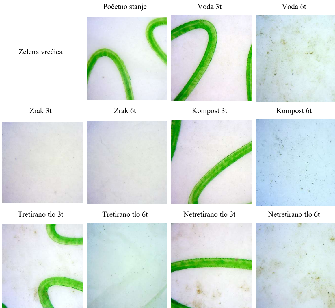
Slika 15. Uzorci zelene vrećice u svim tipovima okoliša i kroz 3 i 6 tjedana izlaganja snimljeni pomoću Dino-Lite mikroskopa pri povećanju od 60x. 3t= nakon 3 tjedna izlaganja, 6t=nakon 6 tjedana izlaganja.
