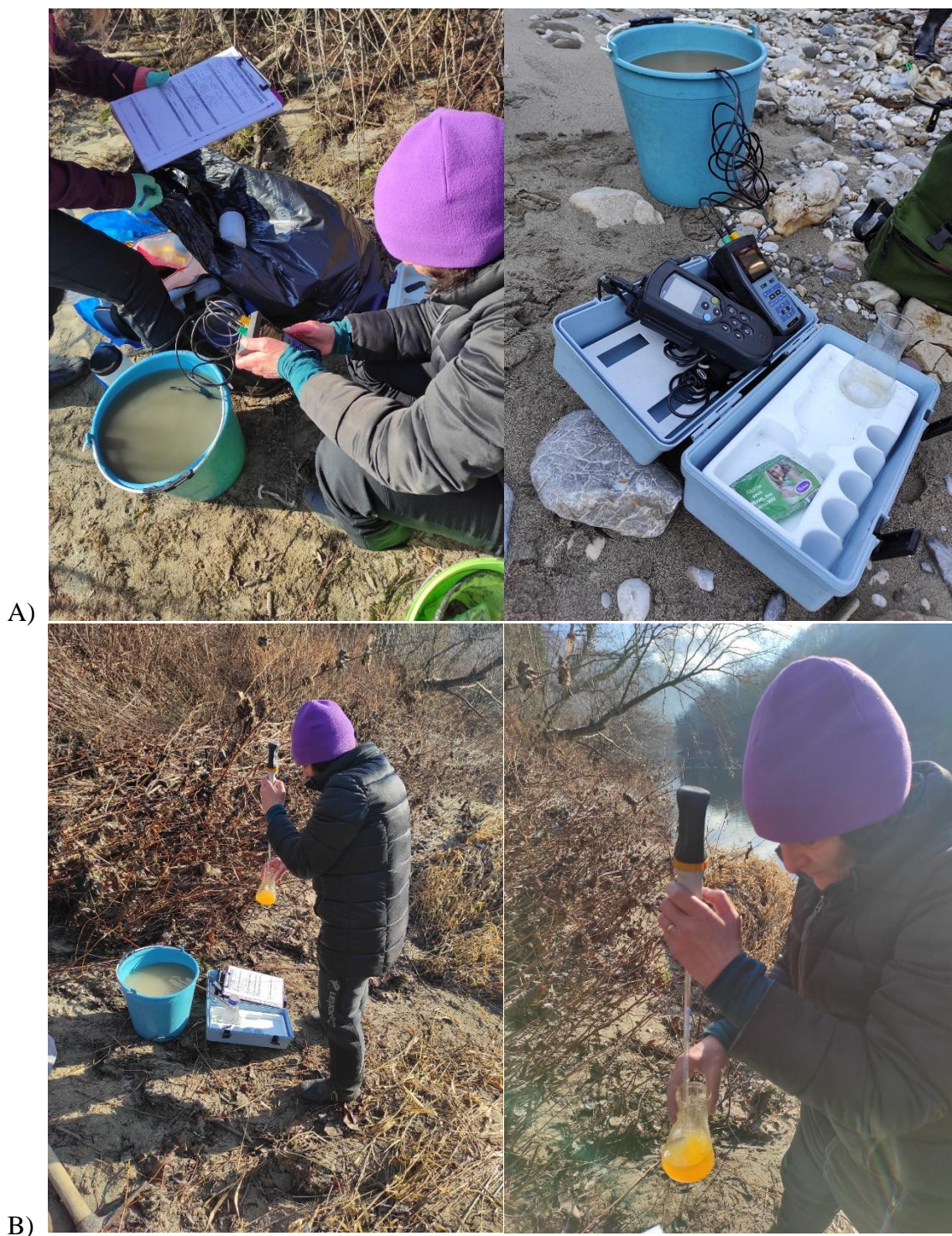
Slika 21. A) mjerenje osnovnih fizikalno-kemijskih parametara vode korištenjem setova sonde; B) primjena titracione metode za utvrđivanje količine kalcij karbonata u vodi ( \text{mg CaCO}_3 \text{ L}^{-1} ).
