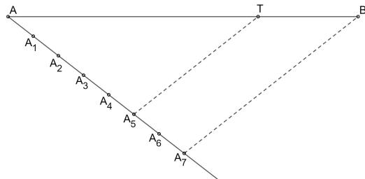
Slika 1.8: Dijeljenje dužine u omjeru 5:2
