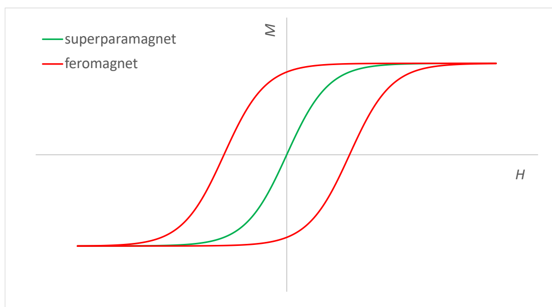
Slika 2.5.1. Krivulje magnetizacije feromagneta i superparamagneta.
