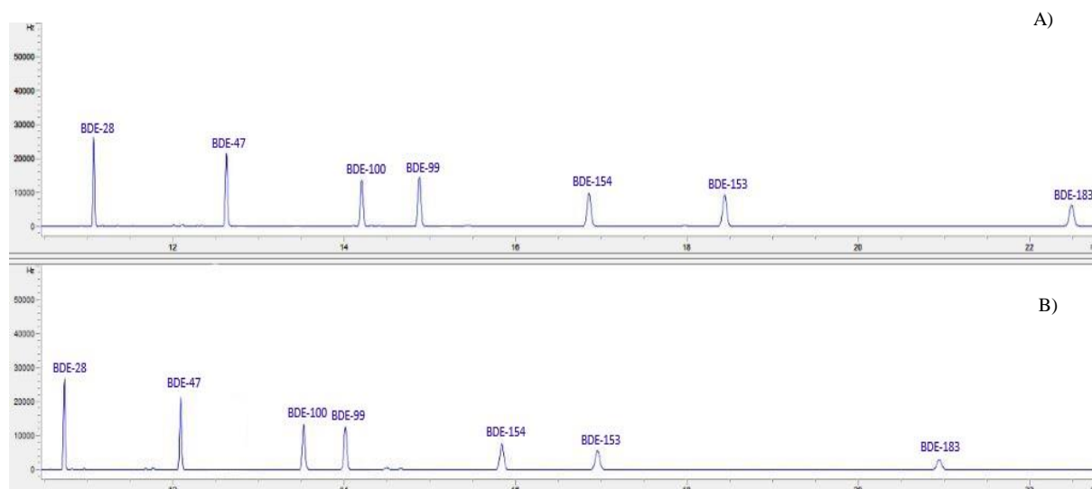
Slika 4.1. GC- \mu ECD kromatogrami standardne otopine smjese kongenera PBDE u n -heksanu masene koncentracije 100 \text{ ng mL}^{-1} na koloni HP-5MS (A) i DB-1701 (B)
