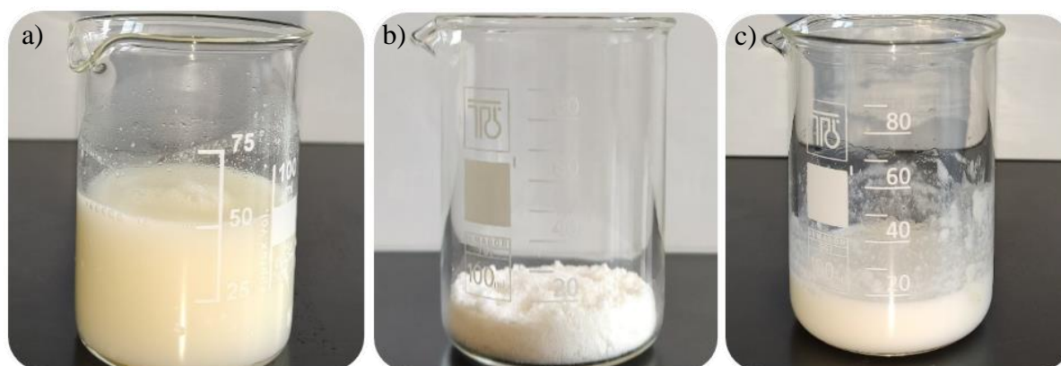
Slika 4.6. Fotografije 50 mL tekućeg mlijeka (a), 5 g liofiliziranog mlijeka (b), 5 g liofiliziranog mlijeka + 10 mL destilirane deionizirane vode (c)
