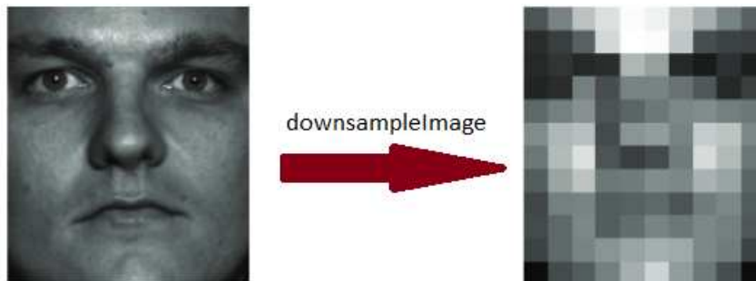
Slika 4.2: Učinak metode downsampleImage na jednoj slici.
