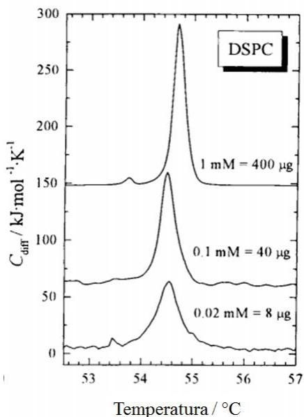
Slika 10. DSC krivulje faznog prijelaza distearoilfosfatidilkolina (DSPC) dobivene pomoću VP-DSC kalorimetra tvrtke MicroCal, Inc.<sup>20</sup>
