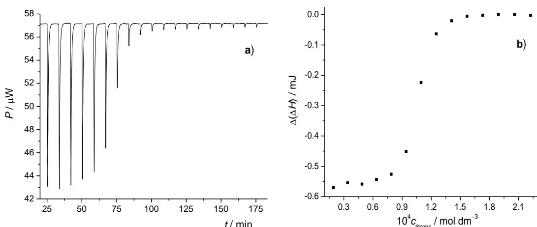
Slika 5. Rezultati mjerjenja izotermnom titracijskom kalorimetrijom. a) ovisnost toplinske snage o vremenu tijekom izotermne kalorimetrijske titracije b) sukcesivne promjene entalpije za svaki dodatak.<sup>7</sup>
