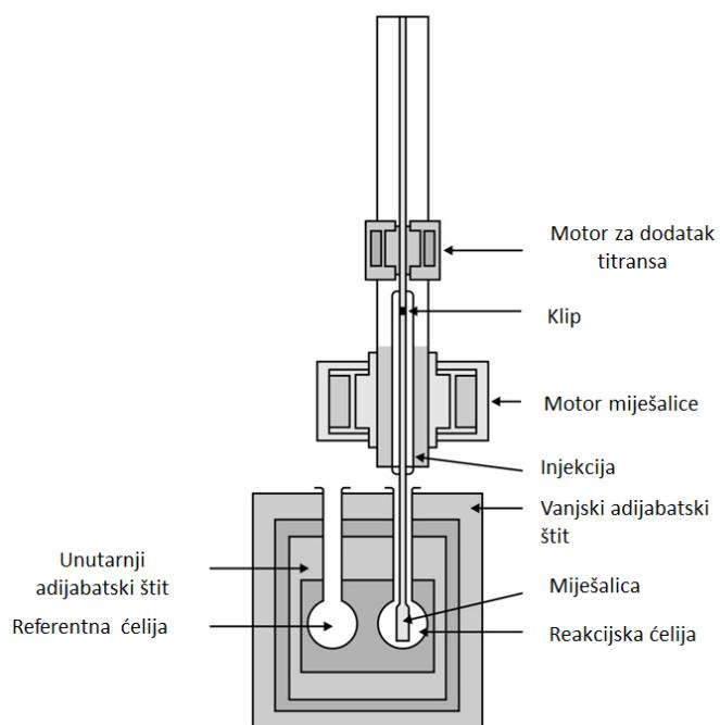
Slika 4. Shematski prikaz kalorimetra za izotermnu titracijsku kalorimetriju (ITC).<sup>9</sup>
