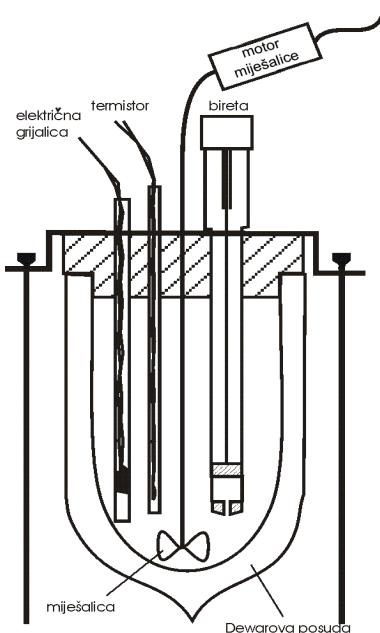
Slika 1. Shematski prikaz izoperibolnog reakcijskog kalorimetra.<sup>5</sup>
