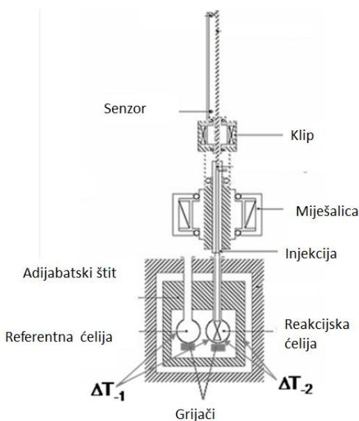
Slika 17. Shematski prikaz dvojnog kompenzacijskog titracijskog kalorimetra.<sup>25</sup>
