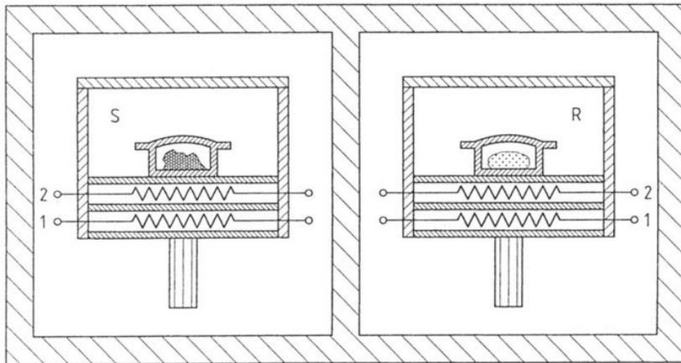
Slika 6. Shematski prikaz kompenzacijskog DSC kalorimetra tvrtke Perkin – Elmer. S prikazuje reakcijsku, a R prikazuje referentnu ćeliju, 1 je grijач, a 2 je termometar. Referentna i reakcijska ćelija su razdvojene, a svaka se nalazi u termostatiranom bloku.<sup>11</sup>
