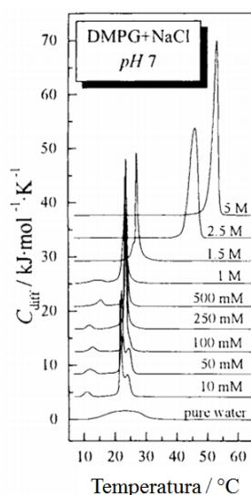
Slika 13. DSC krivulje dimistroilfosfatidatil glicerola kao funkcija koncentracije natrijeva klorida pri pH = 7.<sup>20</sup>
