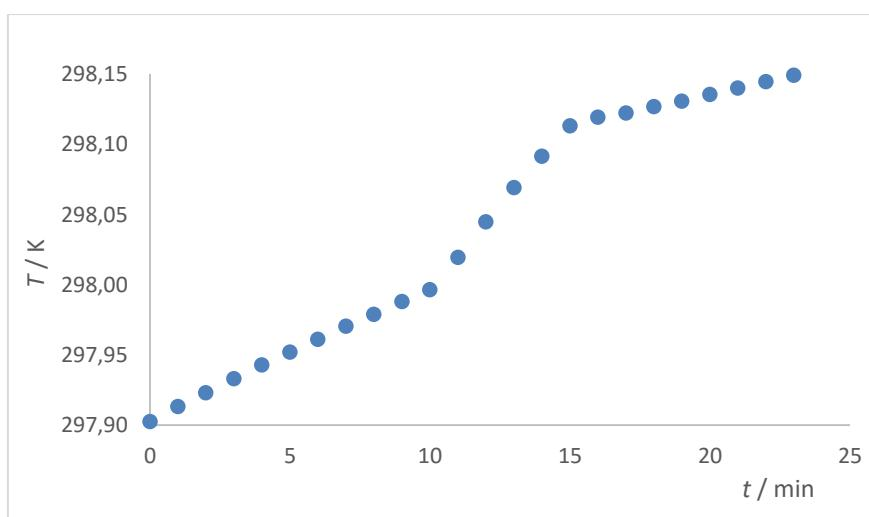
Slika 2. Termogram za reakciju u izoperibolnom kalorimetru.
