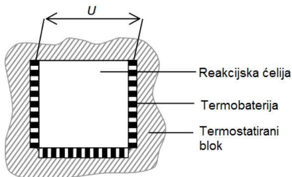
Slika 3. Shematski prikaz principa rada izoternog konduksijskog kalorimetra.<sup>6</sup>
