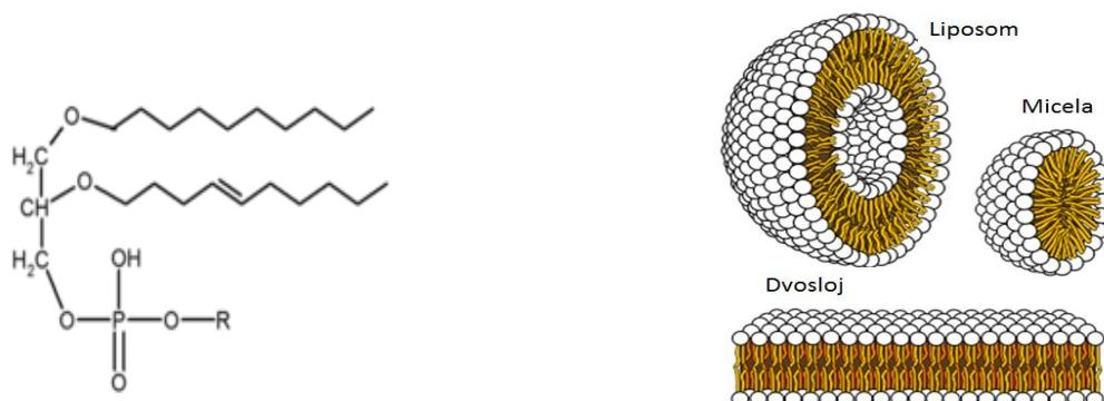
Slika 9. Shematski prikaz fosfolipida (lijevo) i shematski prikaz struktura koje tvore lipidi u vodenim otopinama (desno).<sup>18, 19</sup>
