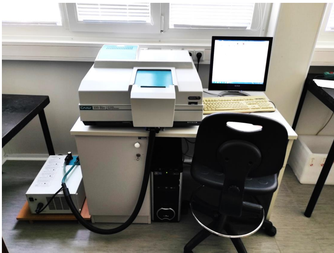
Slika 10. UV/Vis spektrofotometar Cary 100 Bio (Varian) fotografiran na Zavodu za organsku kemiju i biokemiju Instituta Ruđer Bošković
