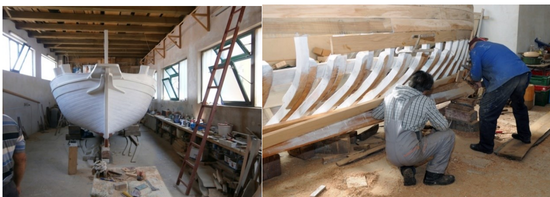
Slika 11. Gradnja betinskih drvenih brodova - gajeta
